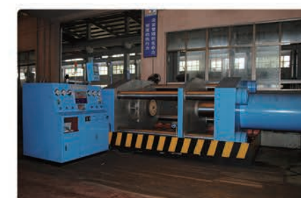
压力试验台 (最大压力PN32; 最大口径DN1200)
